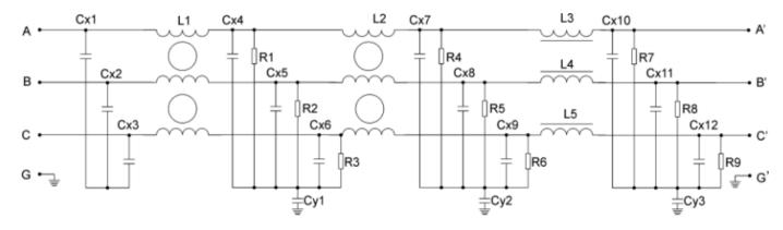
L1=L2 $\ge$ 3 × 18uH L3=L4=L5 $\ge$ 0.36uH Cx1 $\sim$ Cx3= Cx7 $\sim$ Cx9=10uF Cx4 $\sim$ Cx6= Cx10 $\sim$ Cx12=2uF Cy1=1uF Cy2=0.1uF Cy3=2uF R1 $\sim$ R9=1M $\Omega$
